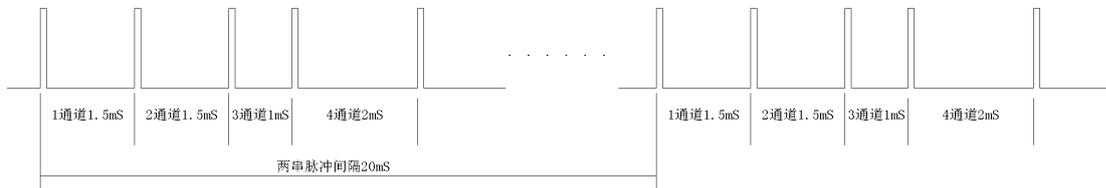
上图为两组 4 通道的脉冲串，每隔 20mS 有一串由 5 个脉冲组成的脉冲串，这个脉冲串可以直接送到发射电路发射，一个脉冲串放大出来如下图所示：
