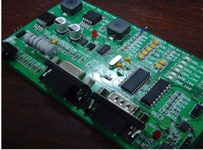
图 8 制作并完成焊接的电路板
